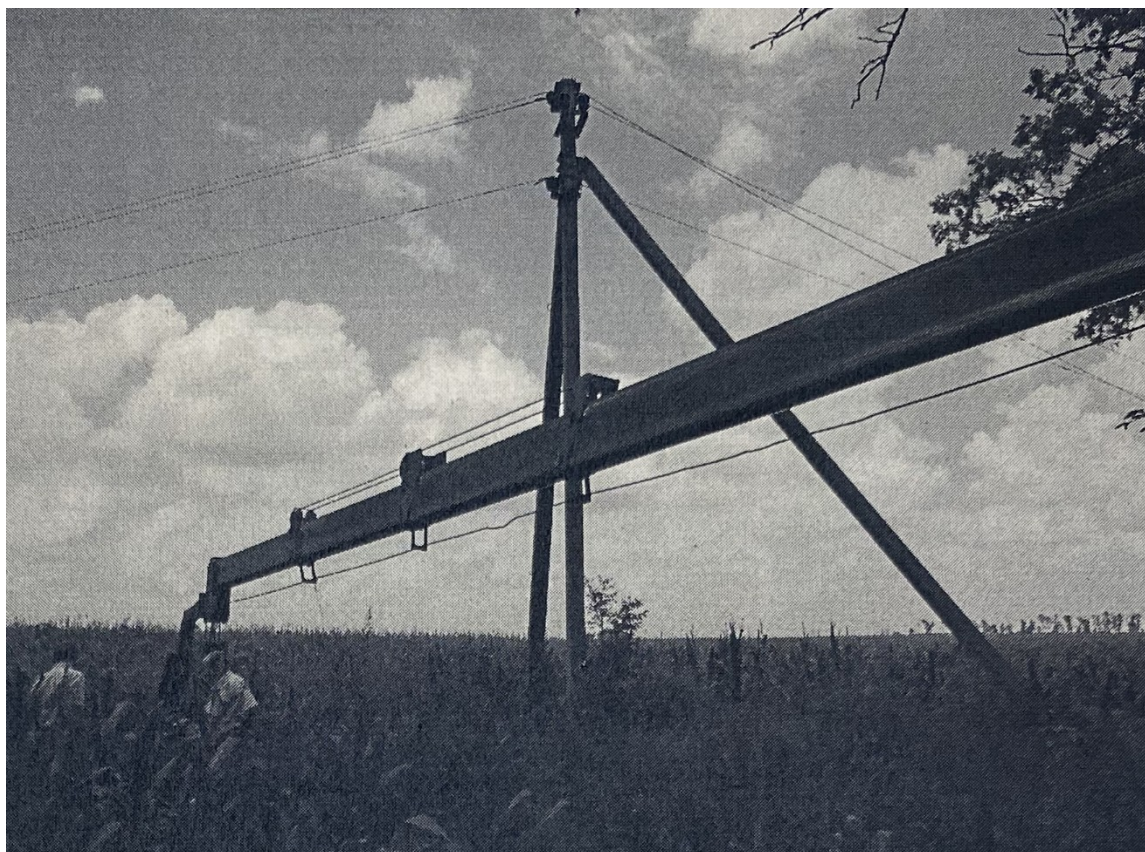
Стрела автовышки грузового автомобиля, подведённая к ЛЭП
